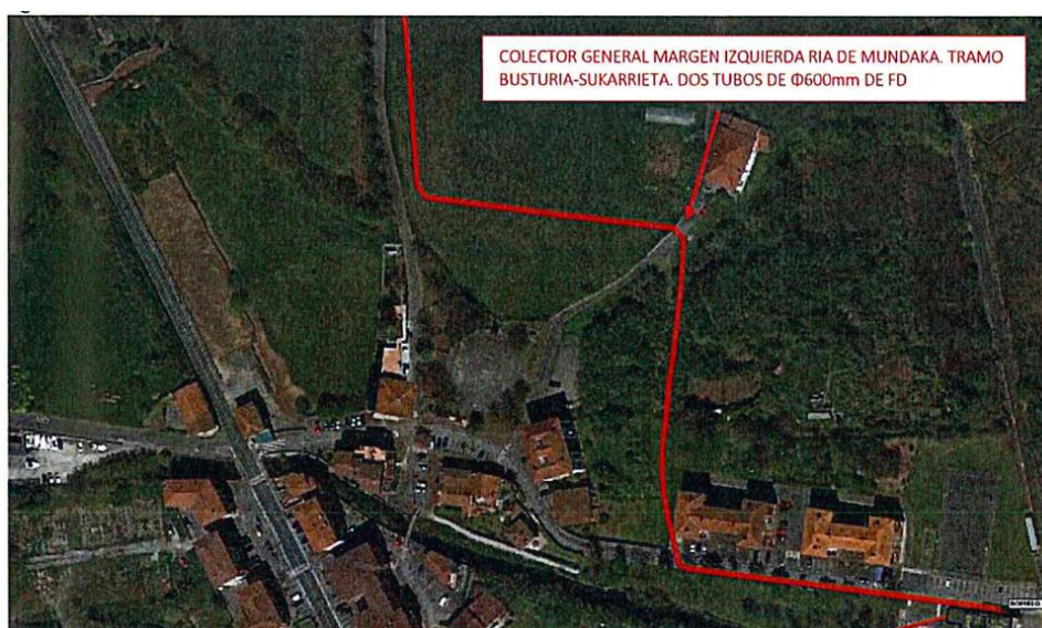
Figura 1. Imagen del colector existente enviada por CABB.
